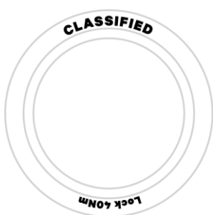
Fig. 3 : Marquage sur la bague de serrage du plateau
